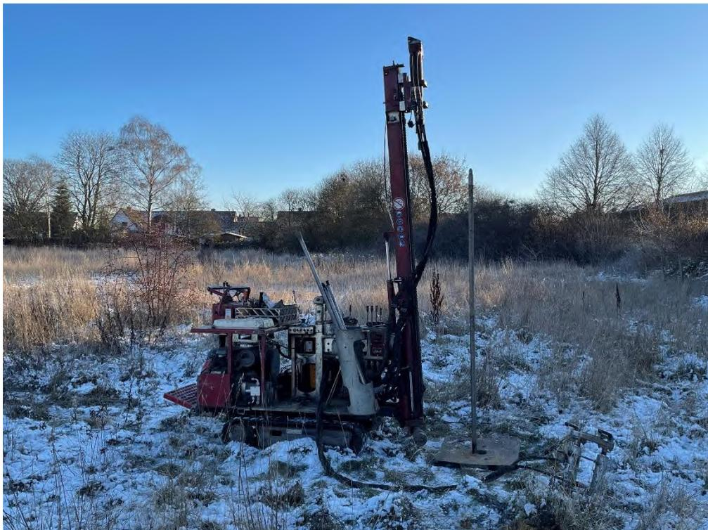
Abb. 5: Bohrgerät für Rammkernsondierungen bei BS 2
