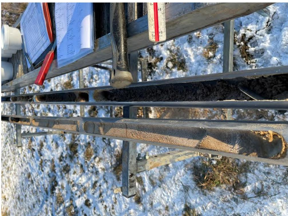
Abb. 6: Erbohrte sandige Schichten mit dünnen rostfarbenen Schlufflagen in der Bohrschappe (BS 2 – Tiefe 2-4m)
